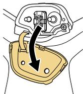
2. Conecte el cable de carga como se muestra en la ilustración.
